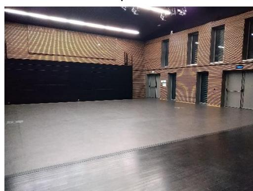
Celle-ci peut être agrandie en empiétant sur la partie public car le plateau est à la même hauteur que la salle. L'ouverture entre les pendrillons est de 9.70m et la profondeur entre le rideau de fond de scène et le rideau de scène est de 7 m. Une armoire de commande permet de piloter le pont de face et les quatre perches motorisées ainsi que le rideau de scène. Des connexions HDMI et VGA permettent la liaison au
